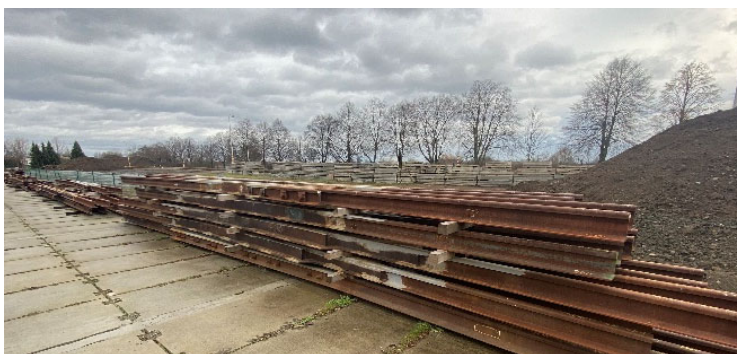
Obr. 2 – Srdcovky na „Servisním skladu“ výrobce
